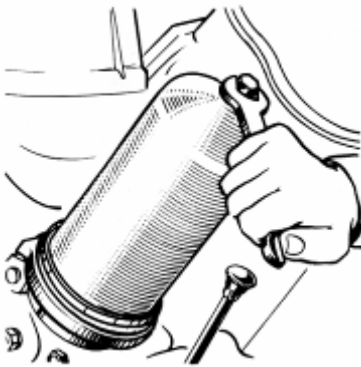
Рис. 61. Отвертывание колпака фильтра
