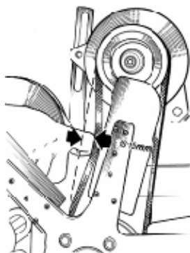
Рис. 53. Проверка натяжения ремня генератора
